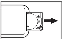
② 引き出すと中にボタン電池が入っていますので、新しいもの（CR2025かCR2032）に交換してください。交換が終わったら電池カバーを戻して交換完了です。
